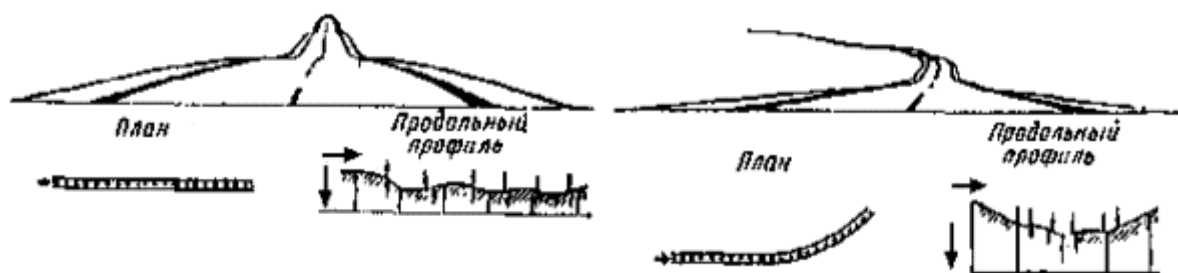
Рис. 19. Нарушение зрительной плавности дороги на участках с обертывающей линией в продольном профиле
