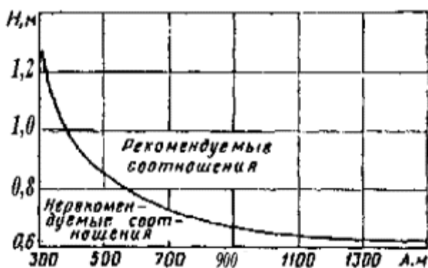
Рис. 38. Соотношение между параметром клотоиды и величиной H, определенной по рис.
