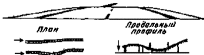
Рис. 33. Нарушение зрительной ясности дороги из-за расположения двух кривых в плане в пределах одной вертикальной кривой
