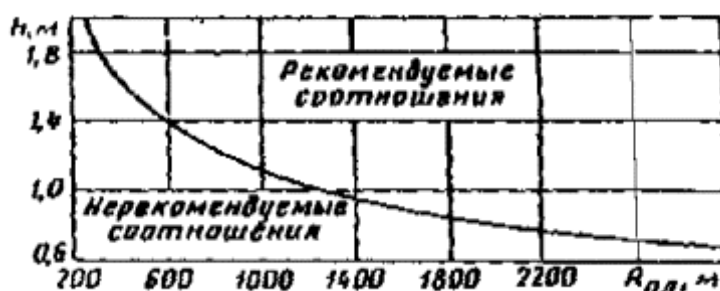
Рис 15. Соотношения радиусов кривых в плане и высот глаз наблюдателей над поверхностью кривой, обеспечивающие зрительную плавность дороги
