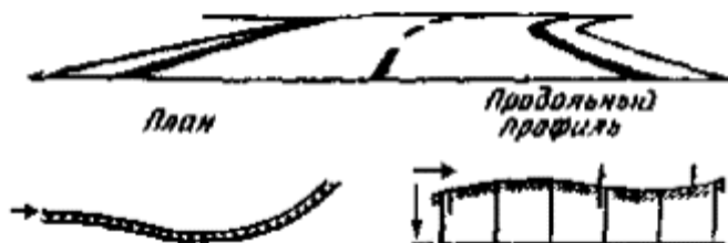
Рис. 32. Нарушение зрительной ясности дороги на участке с извилистым планом трассы и вертикальными кривыми малого радиуса
