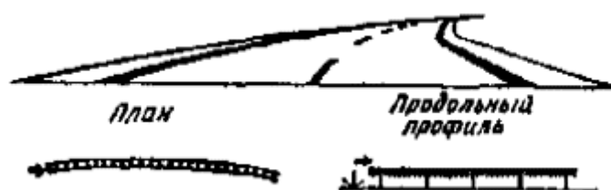
Рис. 18. Нарушение зрительной плавности дороги прямой вставкой в плане трассы
